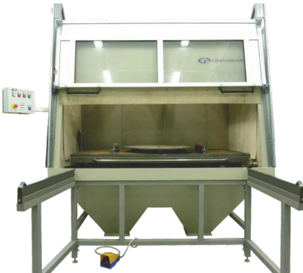
**Камера для гидроабразивной очистки открытого типа** (с возможностью открытой обработки), с замкнутым циклом технологической среды, с ручной обработкой изделий в резиновых перчатках, контроль за обработкой осуществляют визуально через смотровое стекло.
