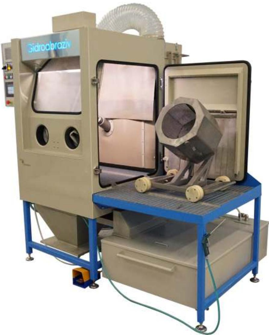
**Галтовка (галтование)** – это процесс групповой обработки поверхности небольших деталей, зачистка от заусенцев, окалины, ржавчины, снижение шероховатости, полирование, ликвидация рисок, царапин.
