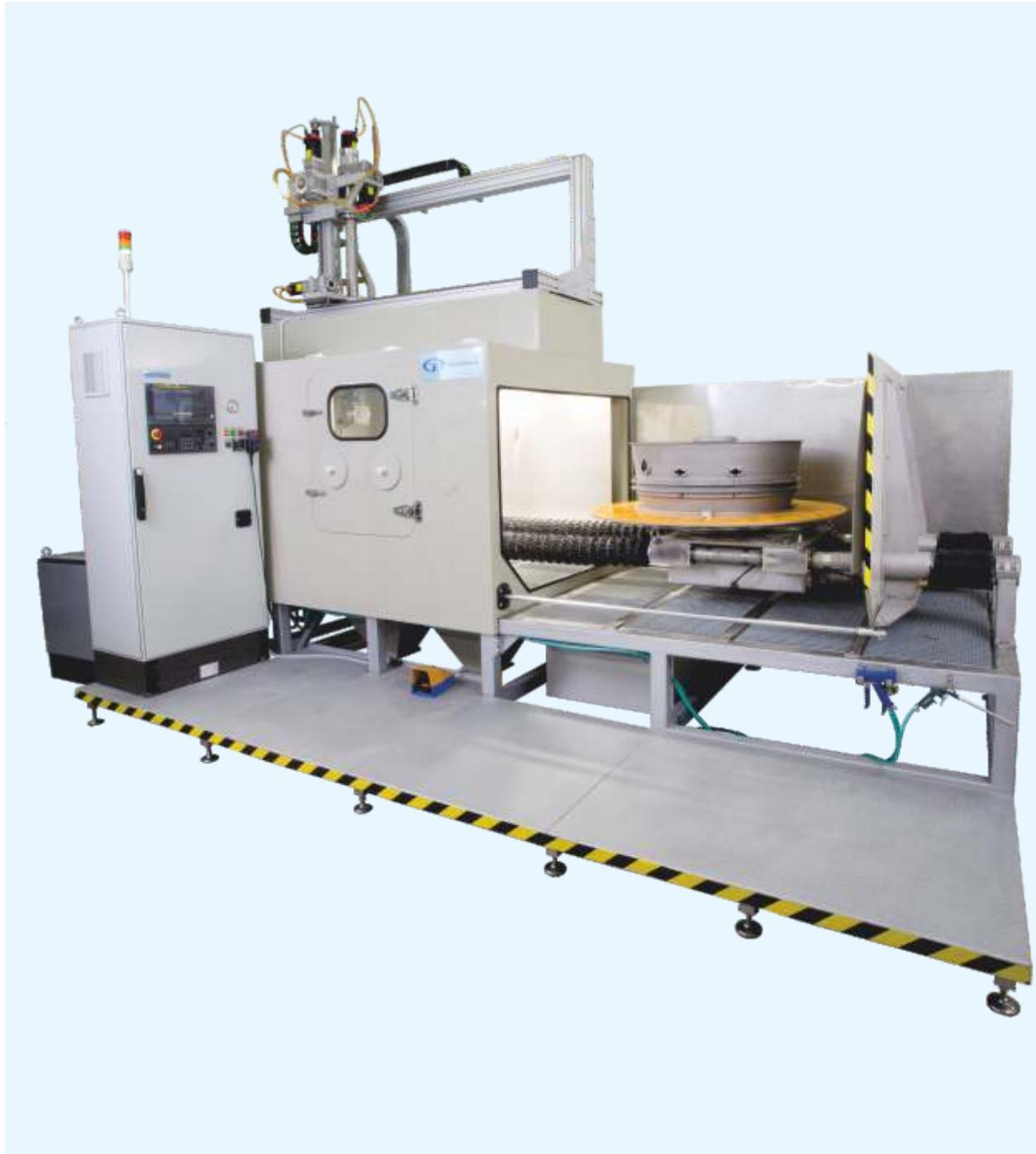
**Установка гидроабразивной обработки КС-150А/5Д с ЧПУ 5-осевая** предназначена для автоматизированной гидроабразивной обработки, очистки, упрочнения, изделий сложной формы с целью удаления нагара, эксплуатационных загрязнений, измененного поверхностного слоя, цветов побежалости, снятия старых покрытий, подготовки поверхности к нанесению покрытия, ликвидации центров будущих растрескаваний, вскрытия микротрещин под дефектоскопию, снижения шероховатости без изменения размеров и геометрии изделий.
