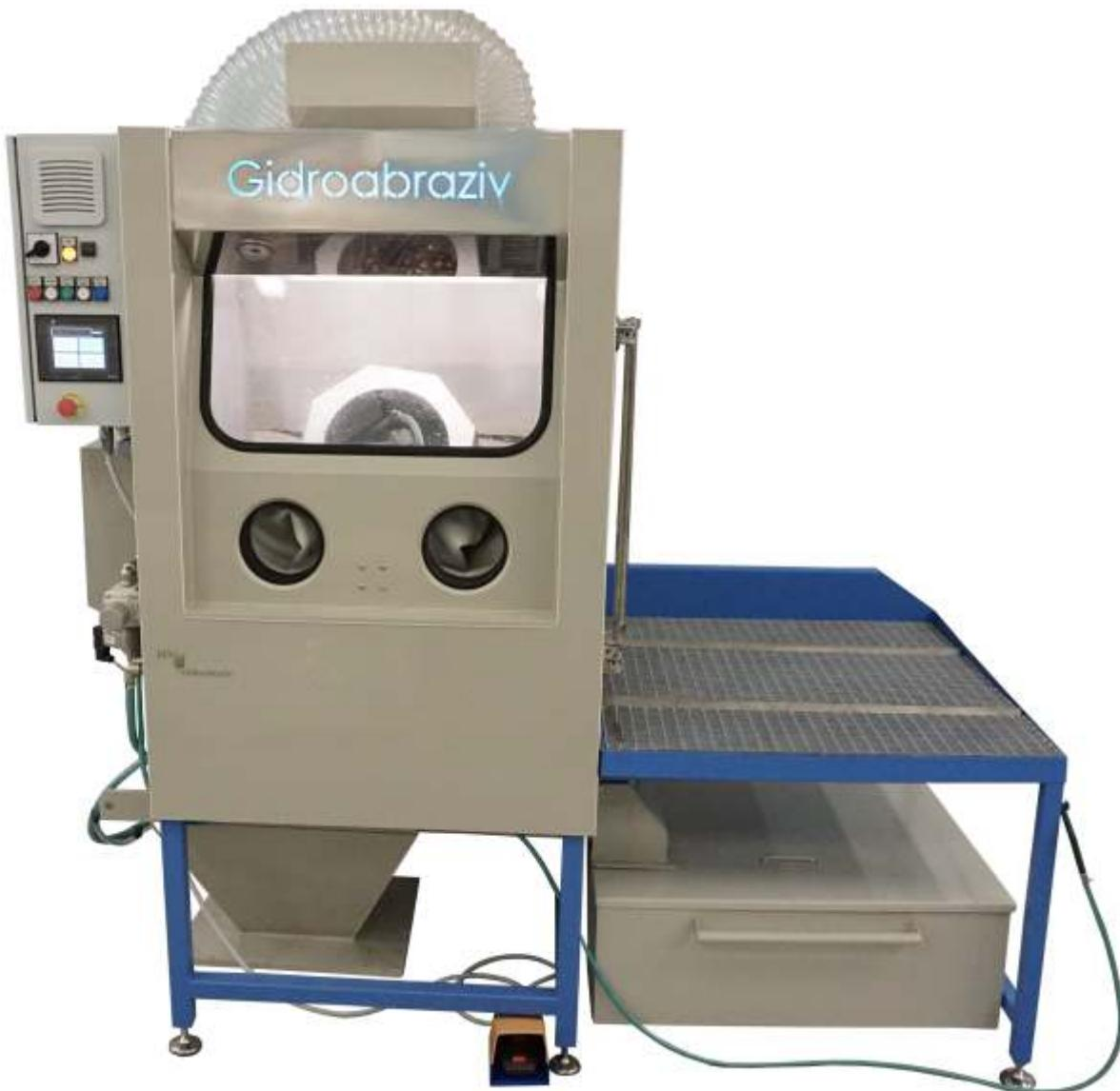
**Камера для гидроабразивной обработки** герметичная, с замкнутым циклом технологической среды, с ручной обработкой изделий в резиновых перчатках, контроль за обработкой осуществляют визуально, через смотровое стекло, врачающийся столик на выдвижном рычаге, выдвижная тележка с врачающимся столиком (Т), выдвижная тележка с галтовочным барабаном (ТГ), галтовочный барабан на врачающемся столике (СГ).
