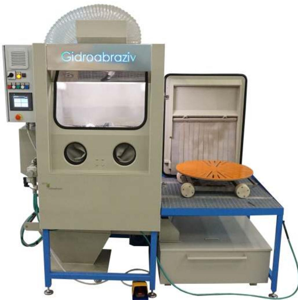
**Установка гидроабразивной очистки КС-100СГД предназначена для струйной ручной обработки изделий на вращающемся столе** через резиновые перчаточные порты и массовой обработки мелких изделий в галтовочном барабане, представляет собой герметичную камеру с ручной обработкой и автоматическим галтовочным барабаном на двери.
