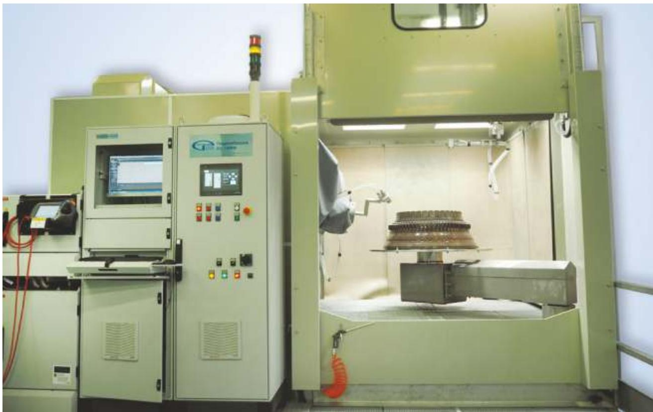
**Установка «КС-150РМ» предназначена для автоматизированной гидродробеструйной обработки (обдувки) изделий сложной формы стеклянными шариками.** Состоит из двух модулей: рабочей камеры и камеры-робота. В рабочей камере находится выдвижной стол-позиционер с планшайбой, 4-координатный манипулятор и рука робота. В камере робота находится непосредственно сам робот. Между камерами стоит мембрана, исключающая попадание абразивной пыли и влаги в камеру робота.
