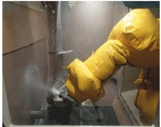
**Установка гидродробеструйного упрочнения КС-150Р/2У с поворотным столом-дверью, роботом, 8-осевая, с двумя сателлитами-позиционерами**
