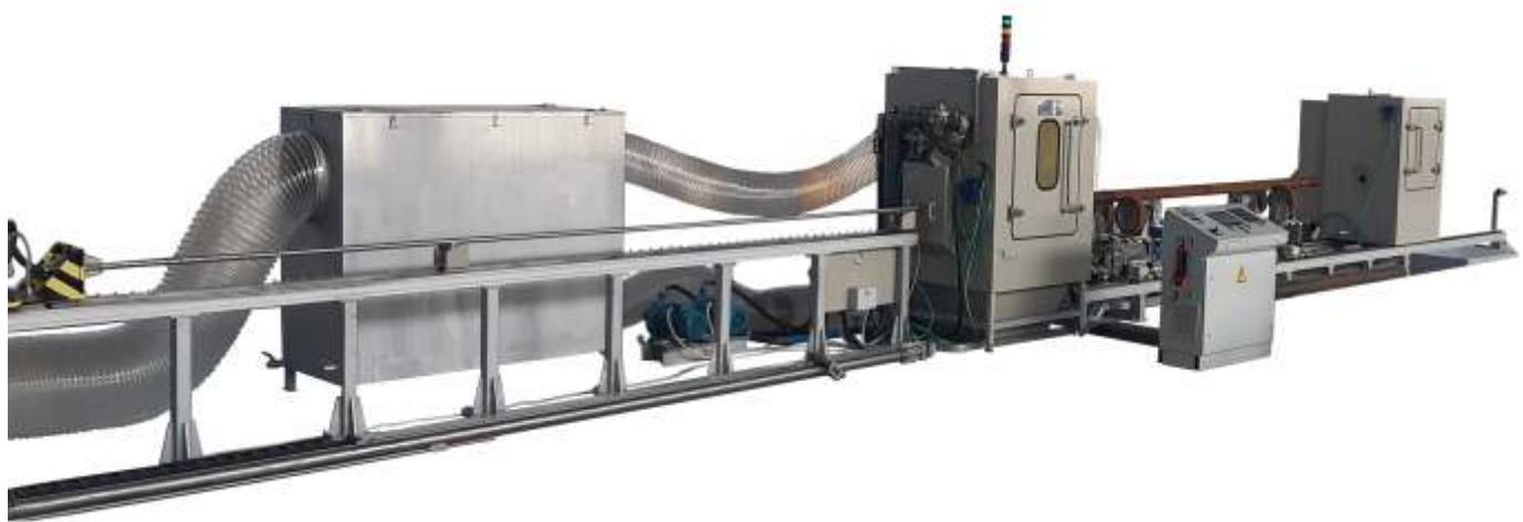
Предназначена для гидроабразивной очистки внутренней поверхности труб от окалины, ржавчины, графитовой смазки, остатков СОЖ, масла, стружки, металлической пыли, с получением степени очистки до **Sa-3** и шероховатости **Ra 2,4–Ra 3,2** для подготовки поверхности к нанесению покрытий.
