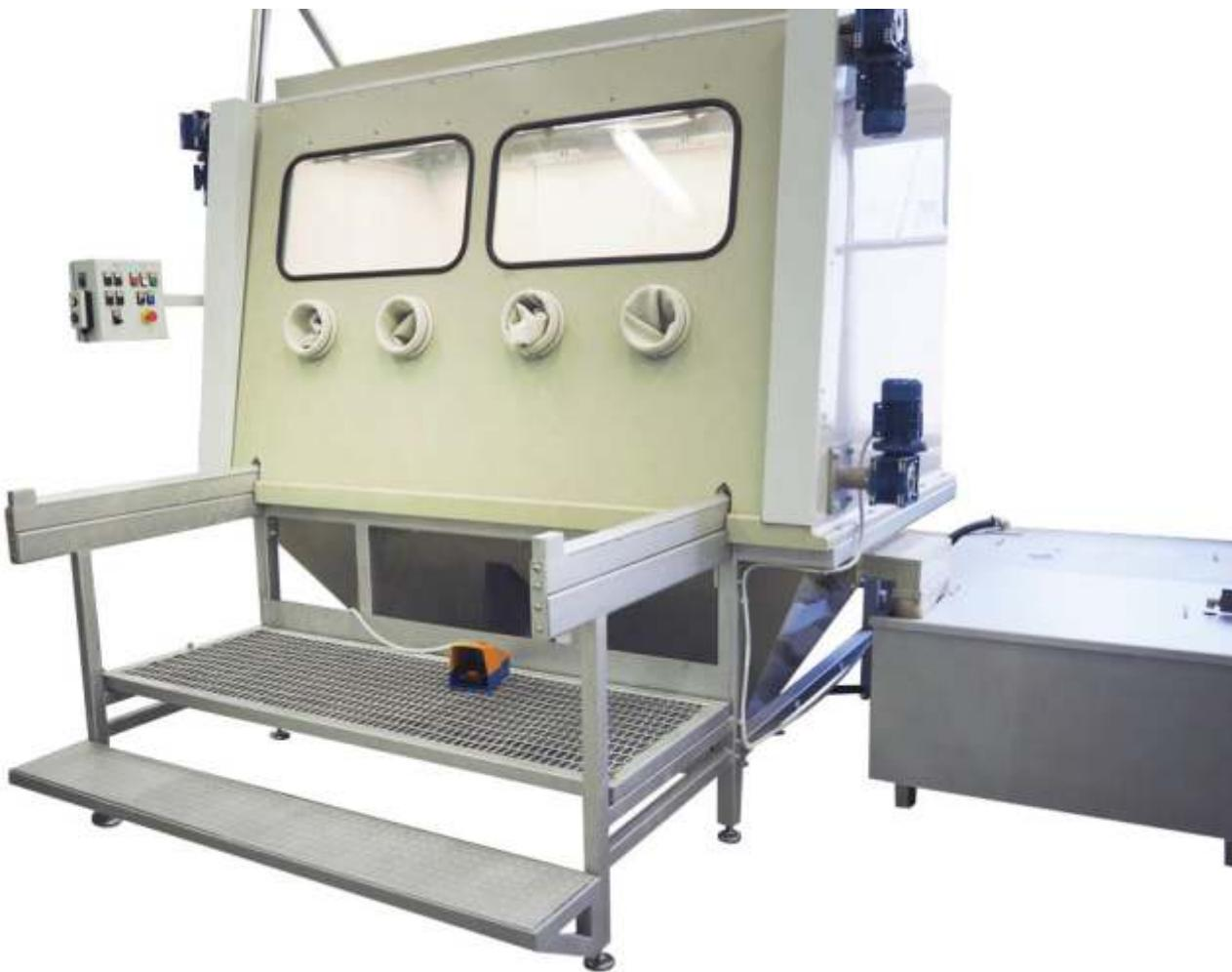
**Камера для гидроабразивной очистки** герметичная, с замкнутым циклом технологической среды, с ручной обработкой изделий в резиновых перчатках, контроль за обработкой осуществляют визуально через смотровое стекло.
