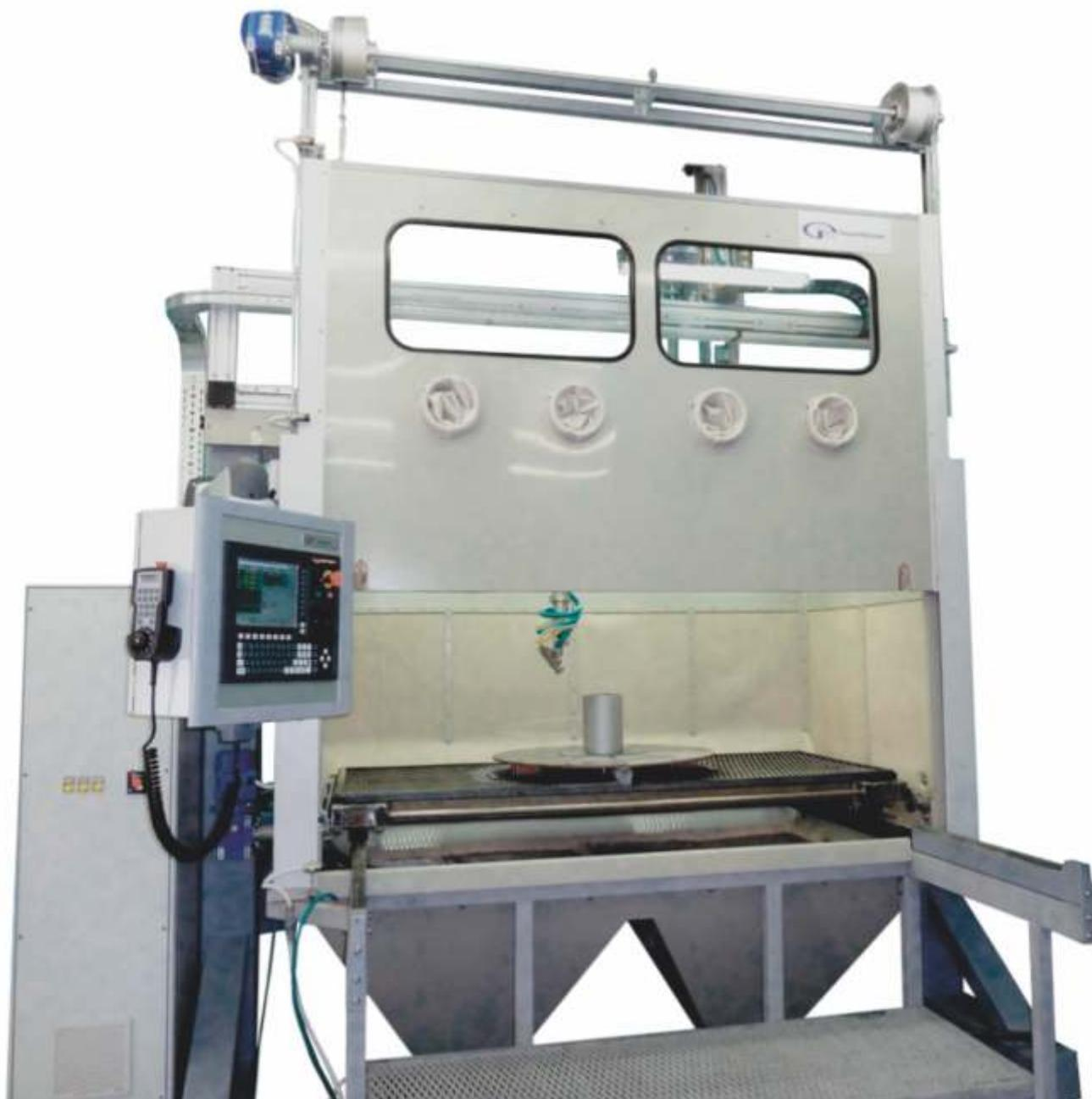
**Установка гидроабразивной очистки (обработки) КС-1402А/5Д** представляет собой герметичную камеру из абразивостойкого полимера, гуммированную внутри светлой резиной, установленную на раме, **4-координатного манипулятора, стола-позиционера, управляемых от ЧПУ.**
