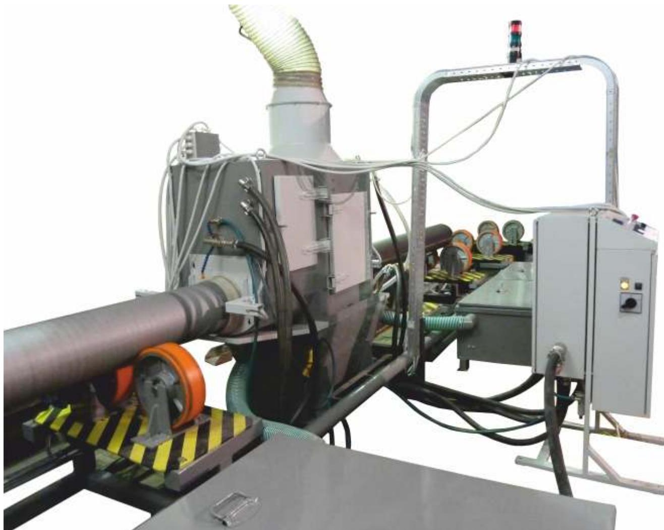
**Автоматическая установка для гидроабразивной очистки наружной поверхности** предназначена для гидроабразивной очистки наружной поверхности труб от окалины, ржавчины, оксидной пленки, графитовой смазки, остатков СОЖ, масла, стружки, металлической пыли, с получением степени очистки до **Sa3** и шероховатости **Ra 2,4–Ra 3,2** для подготовки поверхности к нанесению покрытий.
