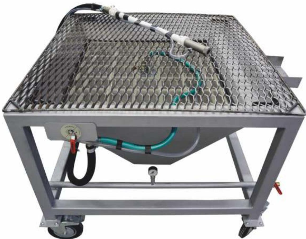
**Установка открытого типа** с принудительной подачей суспензии предназначена для гидроабразивной обработки, очистки различных объектов и изделий с возможностью организации участка с замкнутым циклом воды и абразива.
