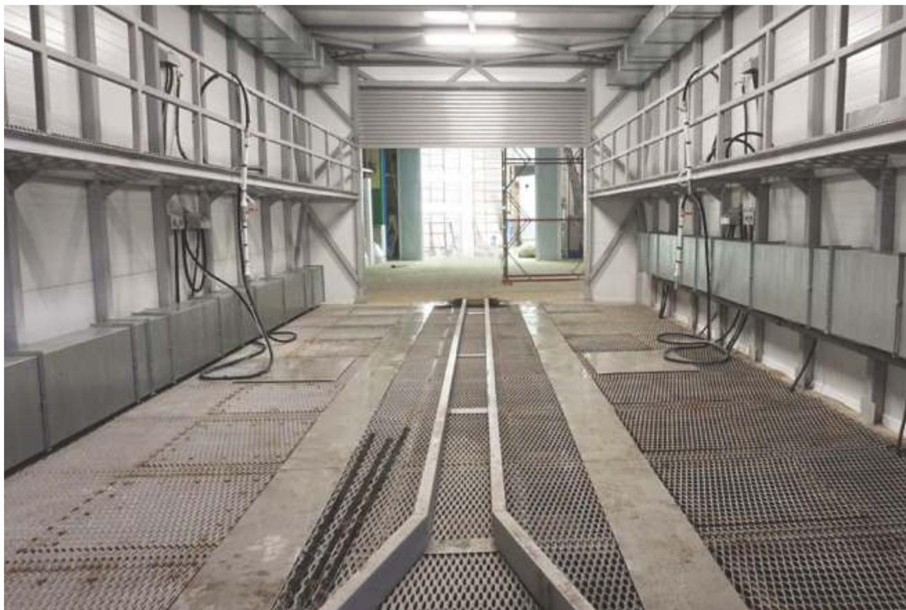
Камера предназначена для гидроабразивной очистки крупногабаритных изделий от окалины, нагара, окисных пленок, цветов побежалости, ржавчины и др. органических и неорганических загрязнений, полученных в процессе эксплуатации и изготовления, для подготовки поверхности перед нанесением лакокрасочного покрытия, с непосредственным участием оператора в зоне обработки.
