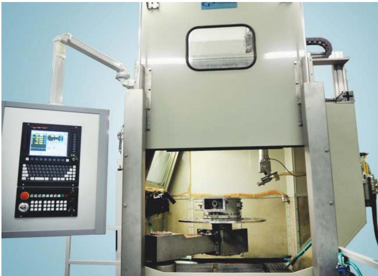
**Установка «КС-150А/5Д» предназначена для автоматизированной гидродробеструйной обработки (обдувки) изделий сложной формы.** Состоит из рабочей камеры, манипулятора, врачающего стола, шламосборника.
