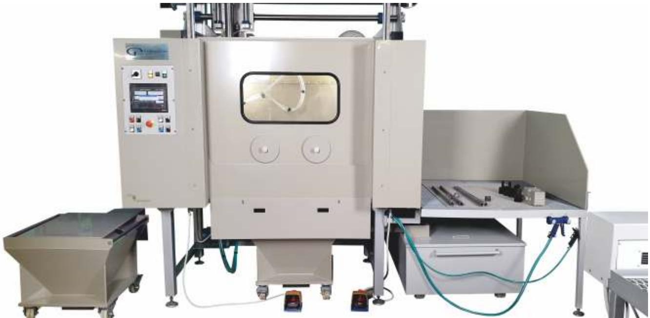
**Установка гидроабразивной обработки КС-120А** предназначена для автоматической обработки оружейных стволов и ручной обработки деталей стрелкового оружия.
