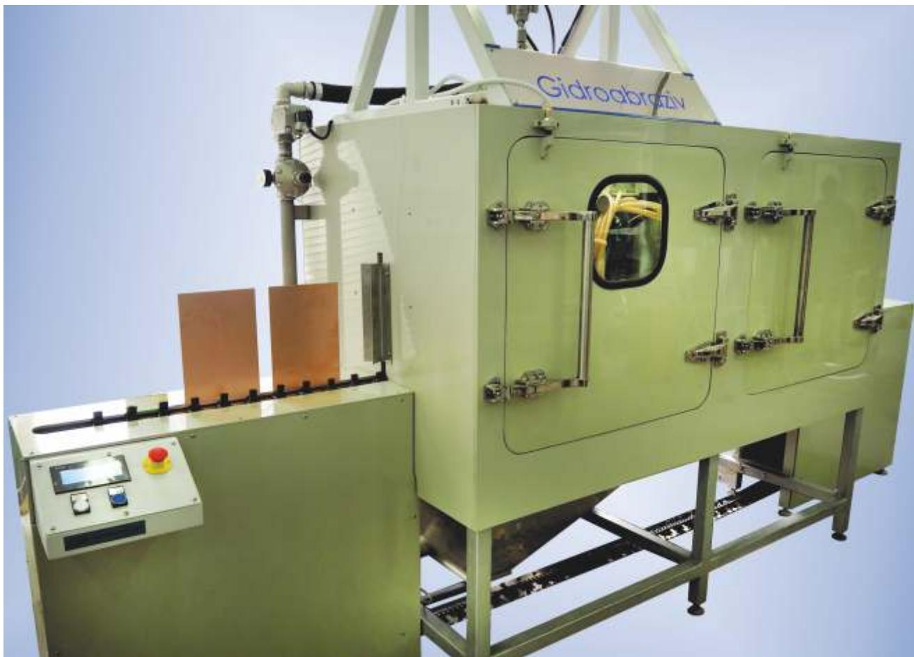
**Установка гидроабразивной очистки печатных плат «КС-400П» предназначена для подготовки поверхности и отверстий в печатных платах под металлизацию** (снятие заусенцев, смолы с торцов контактных площадок, наволакиваемой в процессе сверления, удаление с поверхности обеих сторон фольгированного диэлектрика окисных пленок). Операция очистки включает в себя промывку и осушку печатных плат.
