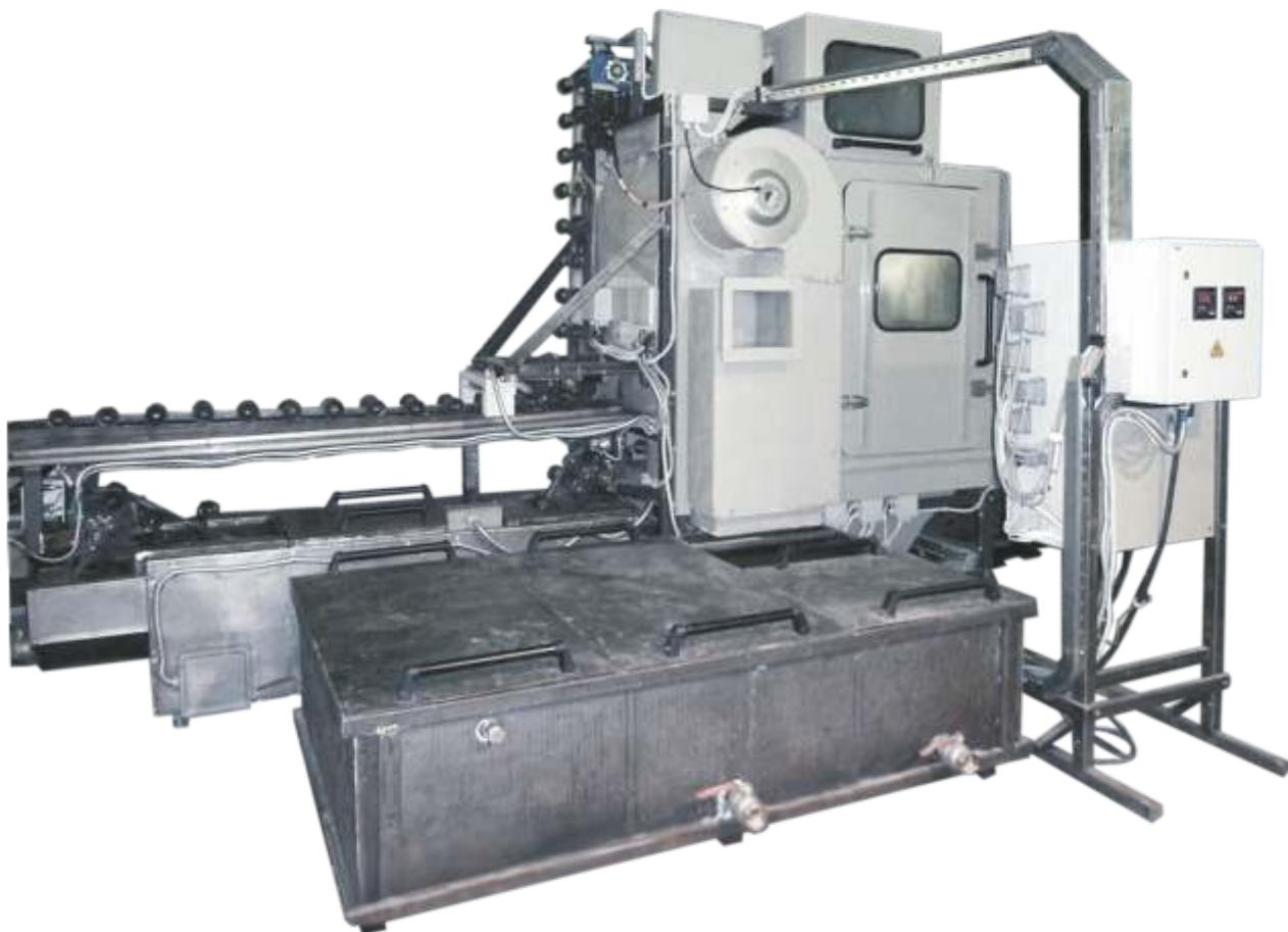
**Установка-автомат для гидроабразивной очистки рабочих колес и направляющих аппаратов секций ЭЦН (Алмаз 30, ТА400, Алмаз 15, Алмаз 25, ТД150, Борец 250, Борец 500 и т.п.), герметичная, с замкнутым циклом технологической среды.**
