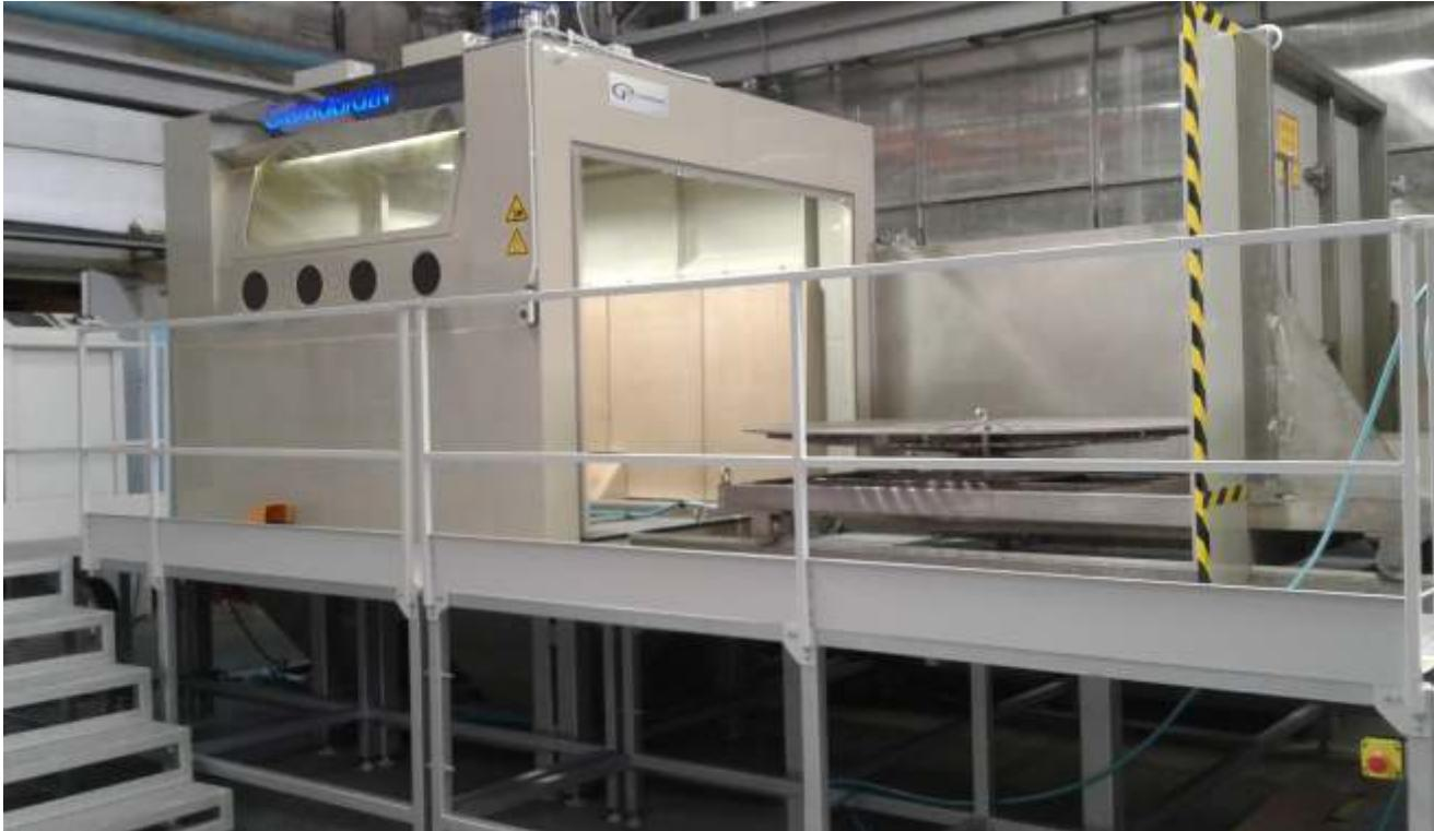
**Установка гидроабразивной обработки (очистки) «КС-200А/5Д/2»** предназначена для удаления окалины, ржавчины, окисных пленок, следов СОЖ, последствий термообработки, старого лакокрасочного покрытия, нагара, для подготовки поверхности под нанесение новых покрытий, а также снижения шероховатости, ликвидации центров будущих растресканий.
