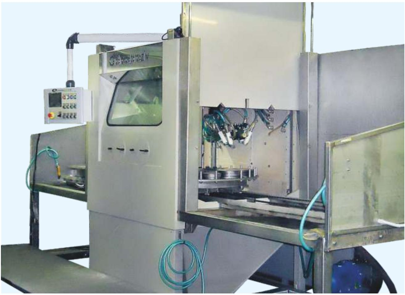
Установка-автомат для гидроабразивной обработки изделий в 3-х координатах в автоматическом режиме, герметичная, с замкнутым циклом технологической среды, с обучаемой траекторией движения.
