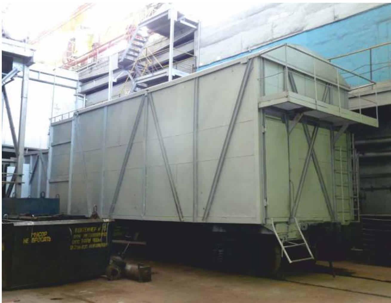
**Передвижная камера гидроабразивной очистки турбин на ж/д платформе ОКП-140** предназначена для очистки поверхности турбин и различных деталей от нагара, ржавчины, окисных пленок и др. эксплуатационных загрязнений, с непосредственным участием оператора в зоне обработки.
