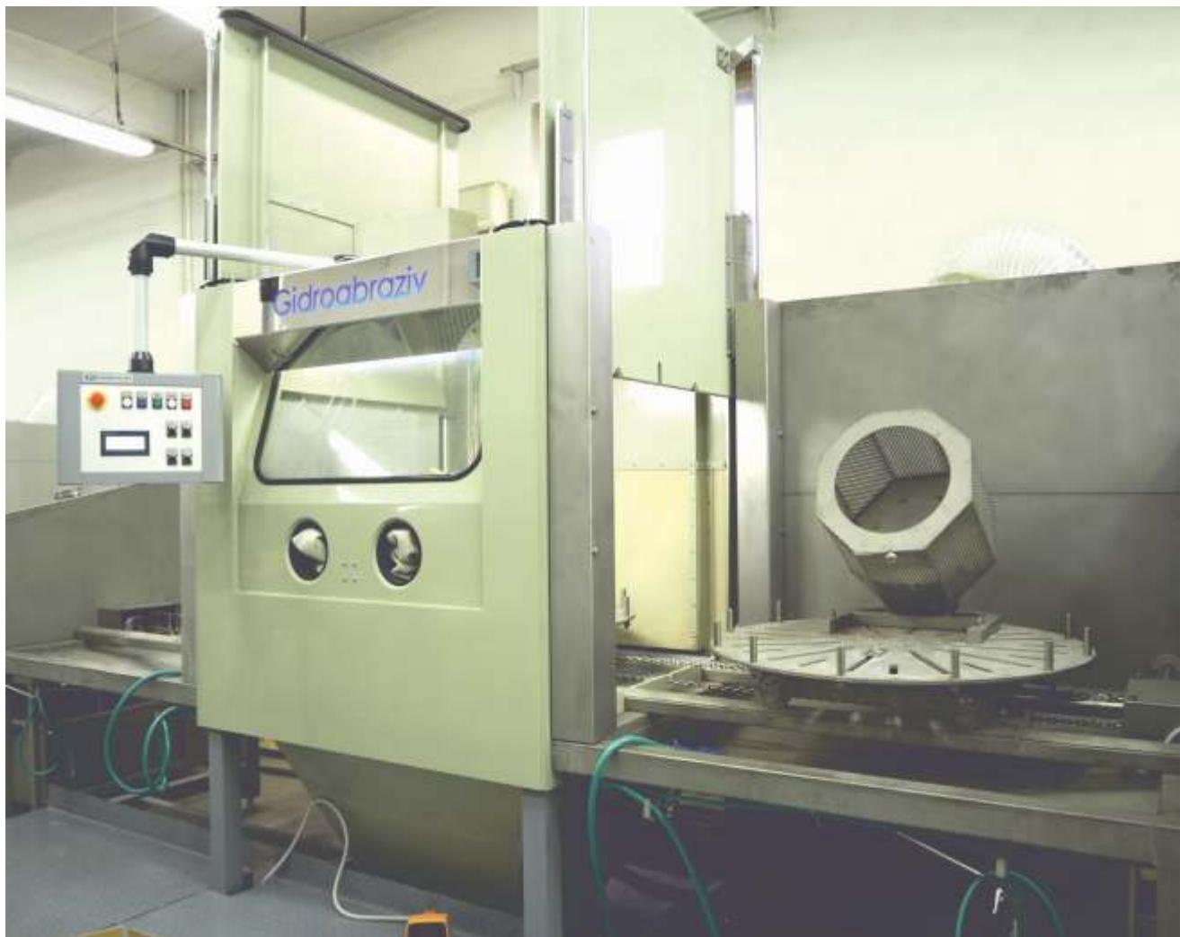
**Установка КС-150ПГ представляет собой герметичную камеру проходного типа с ручной обработкой с двумя столами**, с автоматической массовой обработкой в галтовочном барабане мелких изделий. Установка оборудована двумя загрузочными зонами и двумя тележками для подачи заготовок в зону обработки.
