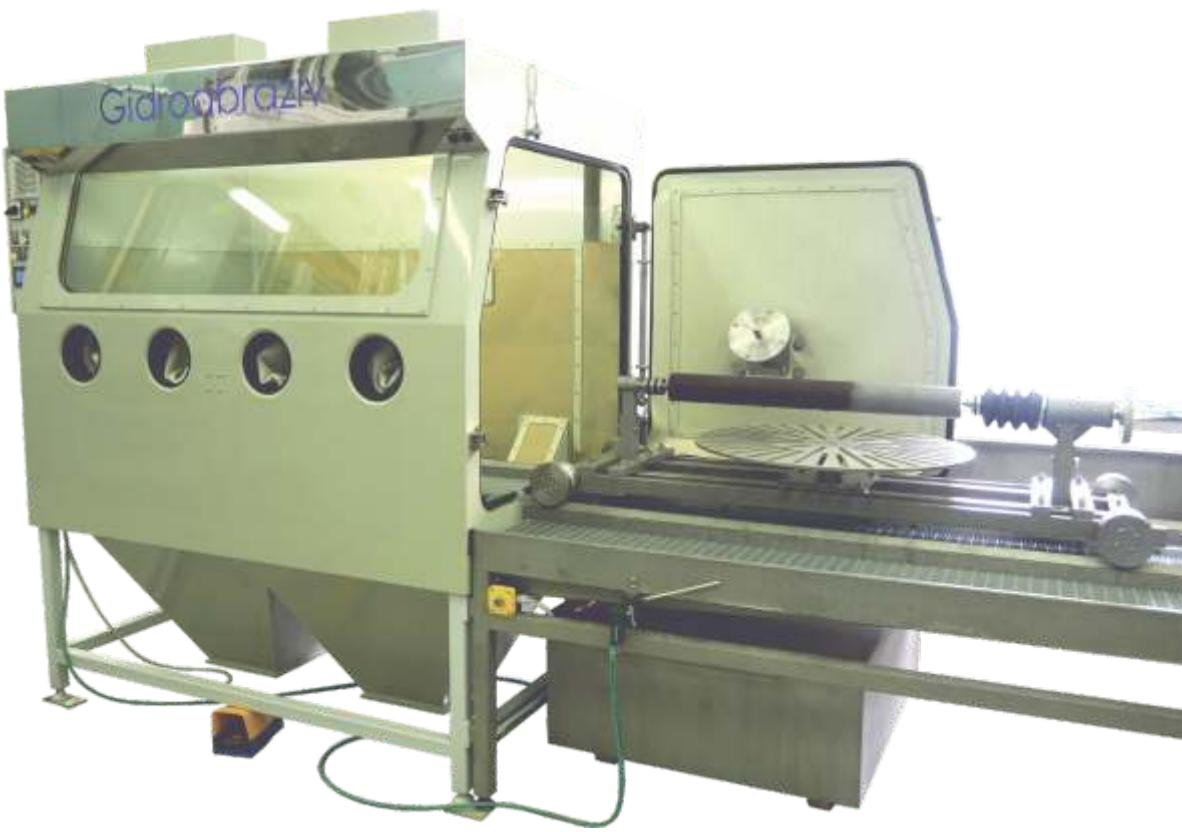
**Установка гидроабразивной очистки КС-140**, с увеличенным рабочим пространством, с ручной обработкой изделий в 4-перчаточных портах, герметичная, с замкнутым циклом технологической среды, выдвижная тележка на разгрузочный столик, галтовочный электрофицированный барабан.
