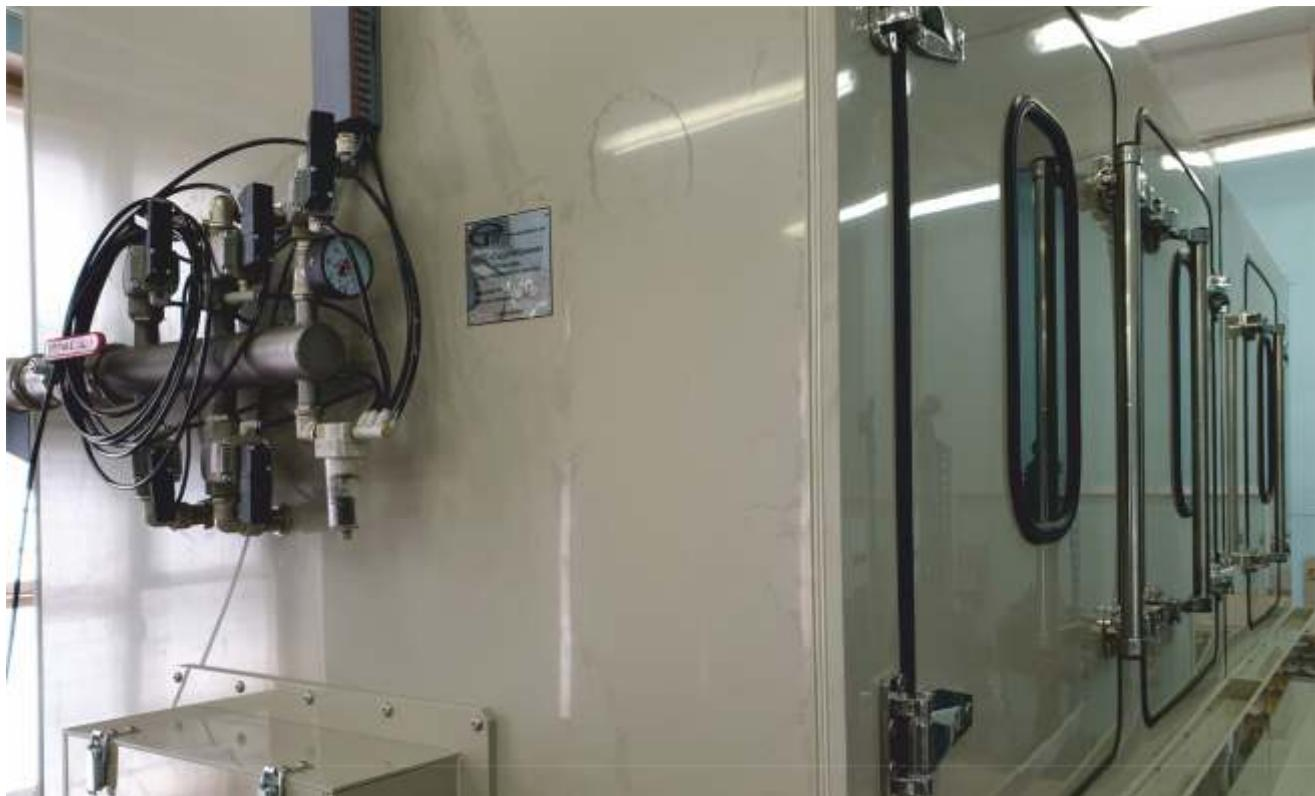
**Установка гидроабразивной очистки пруткового металлопроката** предназначена для удаления окалины, ржавчины, смазки, СОЖ и других загрязнений с проката диаметром от 5 мм до 13 мм в бухтах, от 5 мм до 45 мм в прутках круглого, квадратного и фасонного сечения. Установка может очищать прутковый прокат длиной от 2 до 9 метров и бунтовой.
