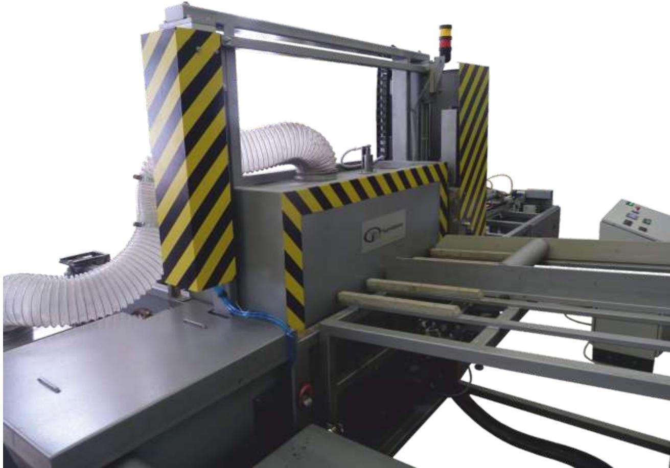
**Установка гидроабразивной очистки наружной и внутренней поверхности коротких труб (одновременно) «КС-КТ»** предназначена для очистки в автоматическом режиме **внутренних и наружных** поверхностей деталей типа «труба», «кофух», **ствол**, **гильза** от нагара, старой краски, ржавчины, окалины, сгоревшего пороха, различного рода загрязнений, обезжиривания поверхностей, а также для подготовки поверхности под покраску и перед нанесением других покрытий.
