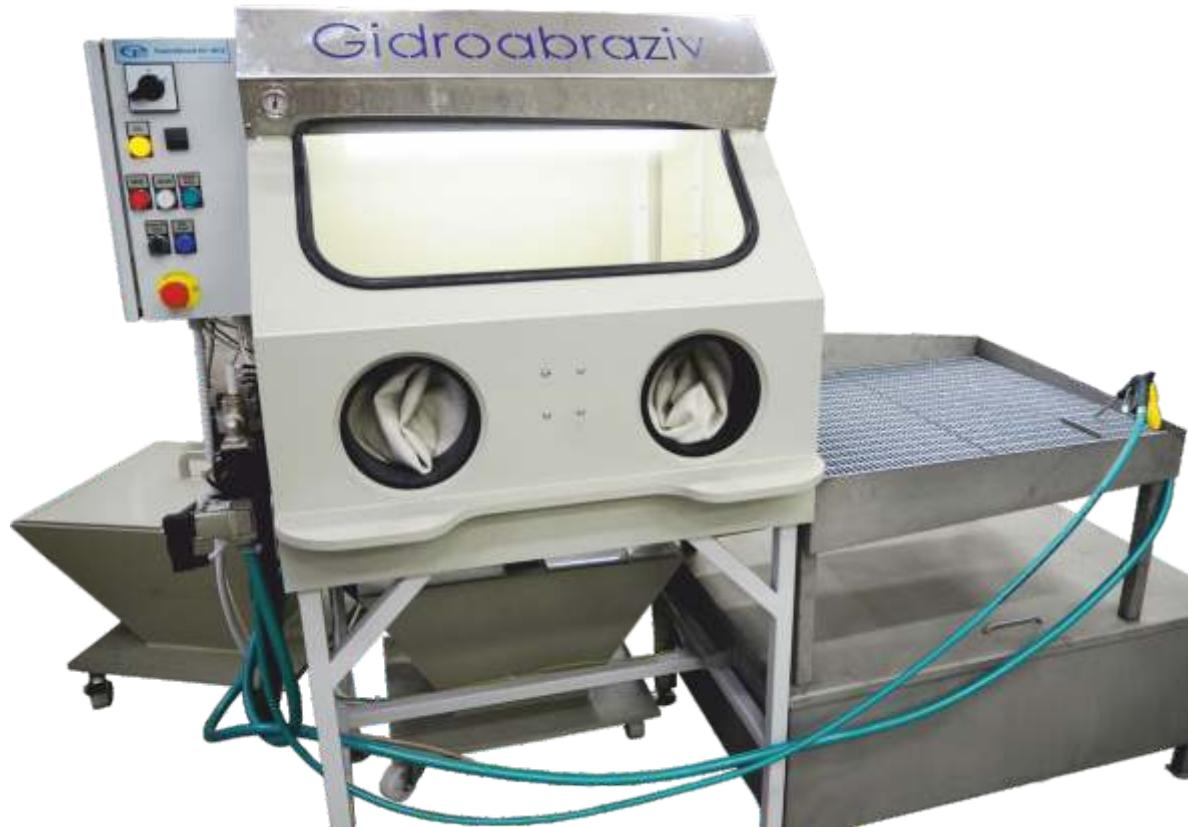
**Мини-камера (парта) для гидроабразивной обработки небольших изделий с возможностью быстрой смены абразивов, герметичная, с замкнутым циклом технологической среды, с ручной обработкой изделий в резиновых перчатках, контроль за обработкой осуществляют визуально, через смотровое стекло.**
