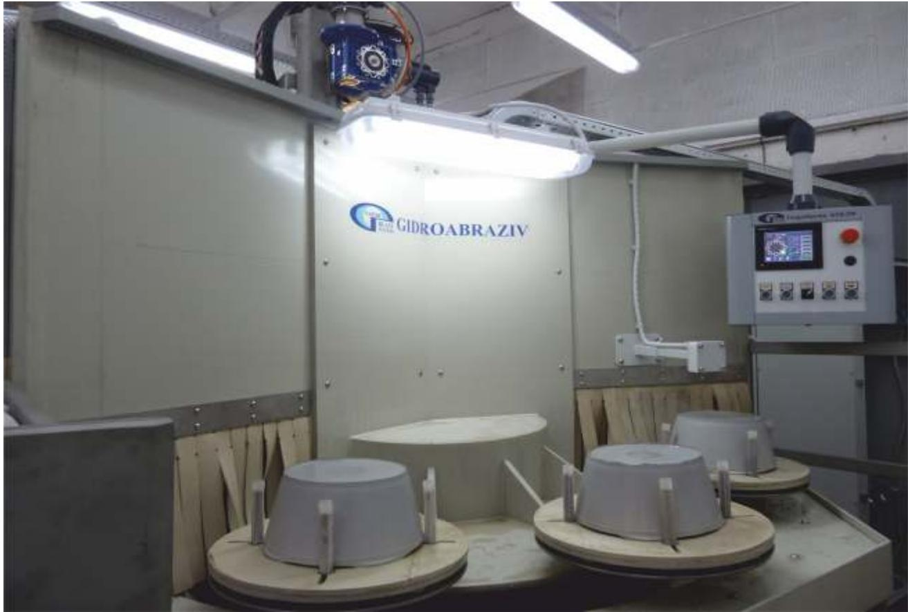
**Установка гидроабразивной обработки тел вращения КТВ-300** предназначена для обработки поверхности деталей, имеющих конфигурацию тел вращения (круглые матрицы, рабочие органы и направляющие аппараты насосов ЭЦН, штампованные посудные заготовки и т.п.), с целью очистки от окалины, ржавчины, окисных пленок, различных загрязнений и придания необходимой шероховатости под дальнейшее нанесение антипригарного, керамического и других покрытий.
