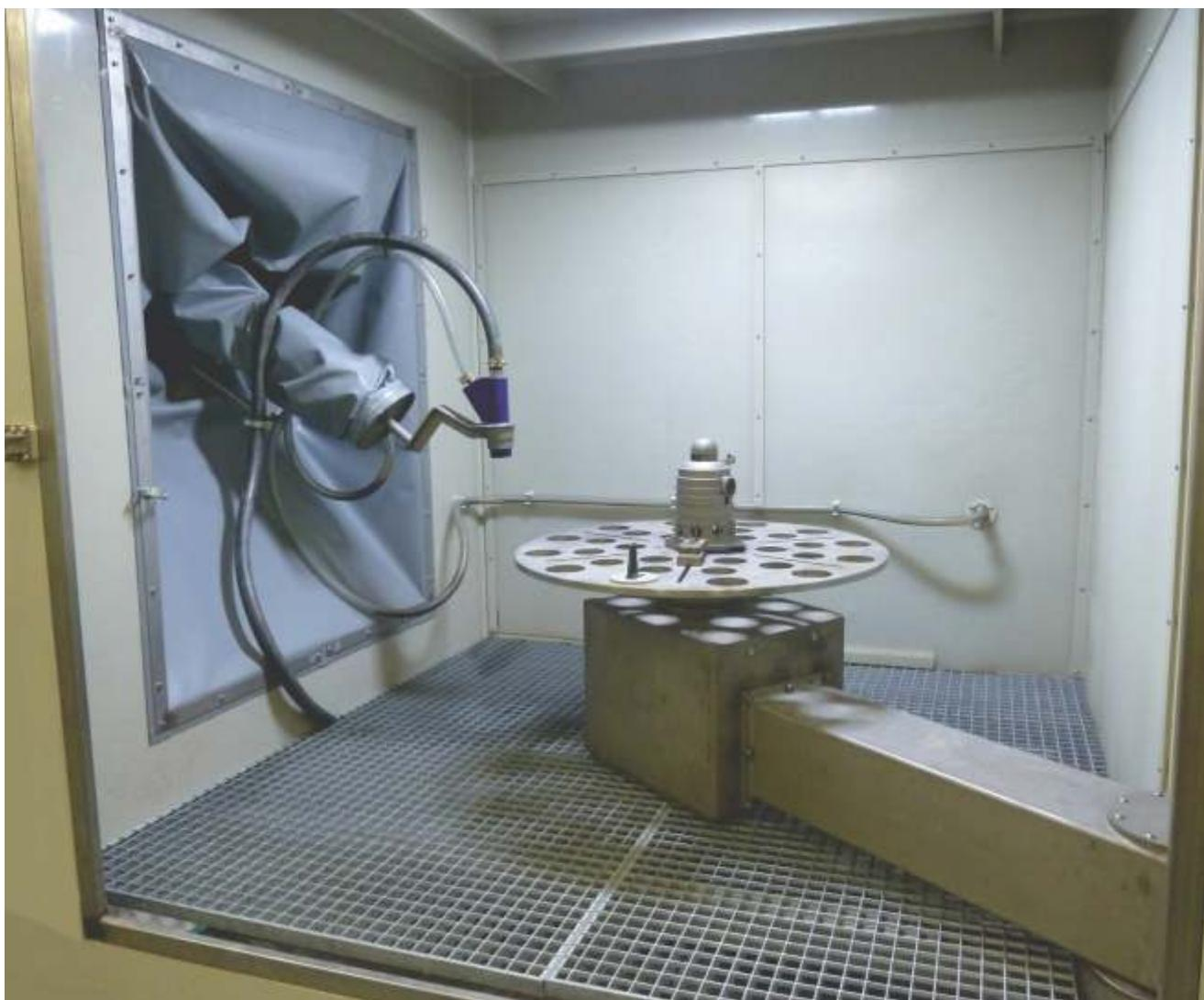
**КС-150Р роботизированная установка** для гидродробеструйной обработки деталей авиационного двигателя при изготовлении и ремонте.
