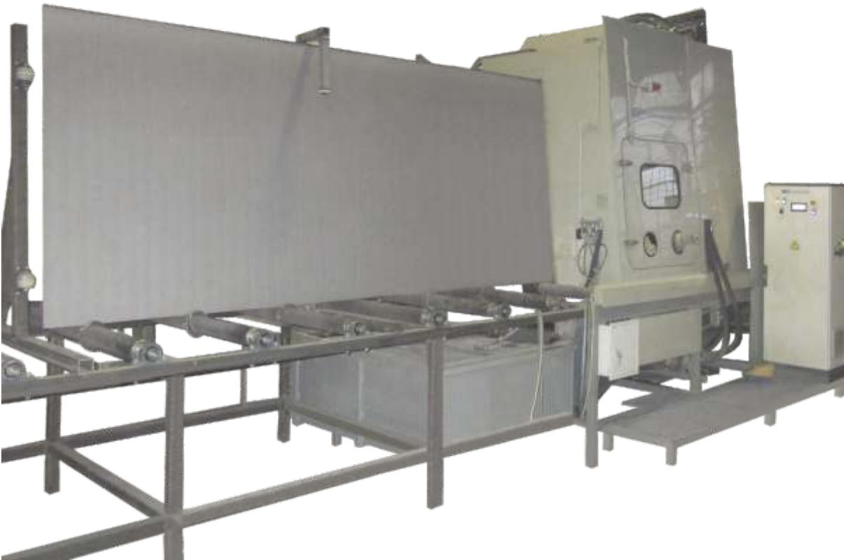
**Установка гидроабразивной очистки листов и проката КЛ-1600** предназначена для очистки листов, профильной трубы, сортопроката от окалины, ржавчины, окисных пленок, масла, подготовки поверхности под нанесение лакокрасочного и порошкового покрытия. Установка проходного типа, герметичная, с отсеками автоматической и ручной очистки, промывки, замкнутым циклом воды и абразива, встроенной вентиляцией.
