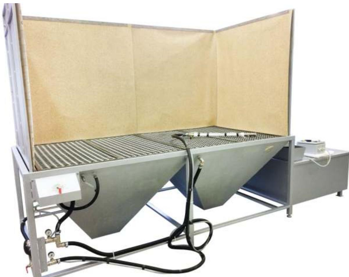
**Технологический узел открытого типа с принудительной подачей суспензии** с замкнутым циклом воды и абразива, предназначен для гидроабразивной очистки крупногабаритных изделий, с возможностью организации широкоформатного участка открытого типа. Технологический узел может располагаться с заглублением, ниже нулевой отметки, либо иметь вид обитаемого подиума.
